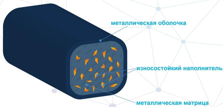
**ИКЭ представляет собой металлическую трубку, заполненную твердым сплавом и залитую металлической связкой (матрицей). Соотношение твердого сплава к матрице составляет 60/40.**
