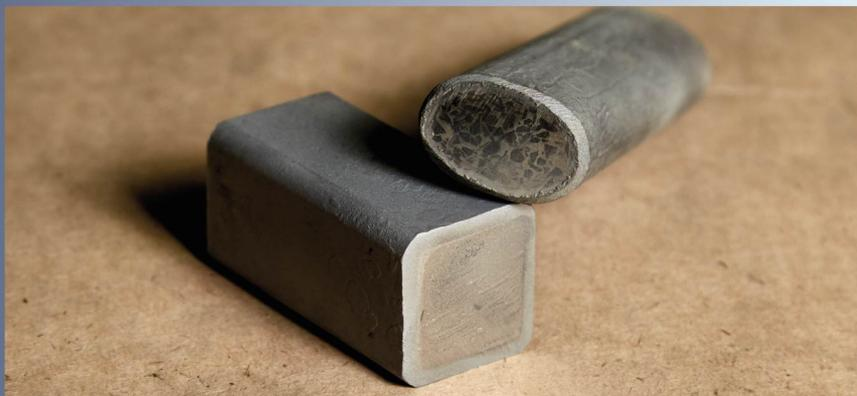
Износостойкий композиционный элемент (ИКЭ) предназначен для установки методом электро- или аргоно-дуговой сварки на детали машин, работающих в условиях интенсивного абразивного изнашивания с умеренными ударными нагрузками с целью придания трущимся поверхностям высокой износостойкости.
